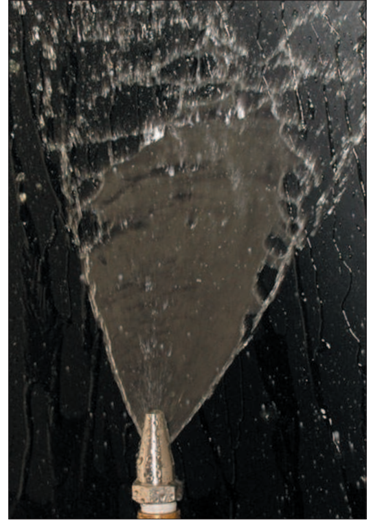
Tipo / Type OLP pressione/pressure 0,3 BAR
